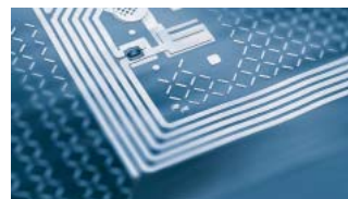
RFID-Tag mit Chip und Antenne
